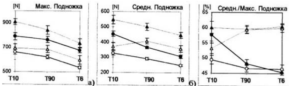
Рис. 7. Усилия на подножке при гребле на различных снарядах: аксимальные (а), средние (б) и отношение средних усилий к максимальным (в)
